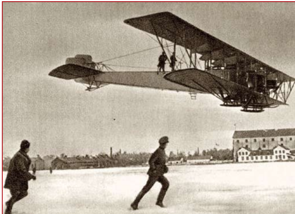
1914 г. Корпусной аэродром. «Илья Муромец» идет на посадку. Во время полета можно было выходить на фюзеляж, а по крыльям добираться до моторов
